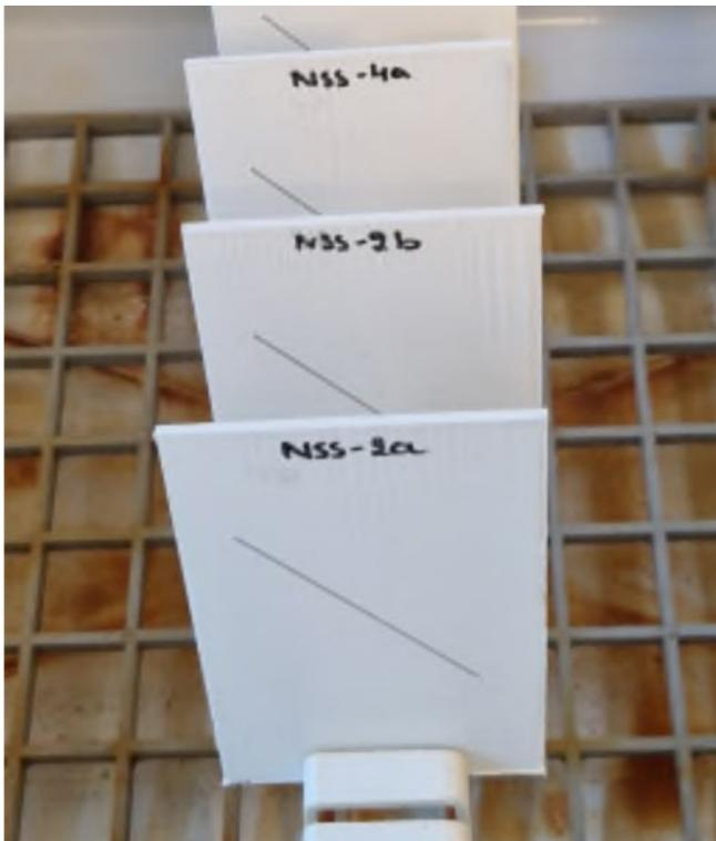
Dans ce test, des incisions délibérées sont pratiquées dans la surface du joint d'étanchéité jusqu'au niveau du métal.
