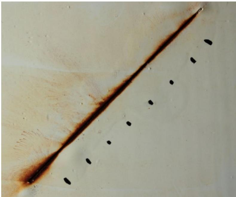
Sur les éprouvettes en acier, la rouille se produit comme prévu et il n'y a qu'un détachement très limité autour de la coupe appliquée
