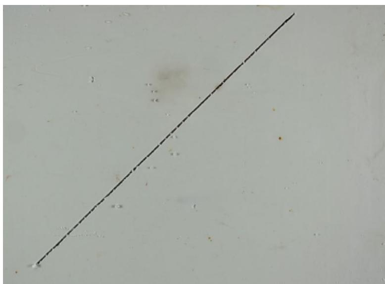
Les résultats sur l'aluminium (exposition à un spray d'acide acétique) sont peut-être encore plus impressionnantes. L'aluminium ne rouille pas, mais des défauts de corrosion locaux peuvent apparaître. Ces tests ont montré que pratiquement aucune corrosion n'était visible. Tec7 offre donc clairement une protection anticorrosion très élevée sur l'aluminium.
